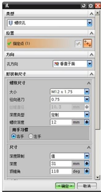
图 7.34 M12 螺纹孔的创建
