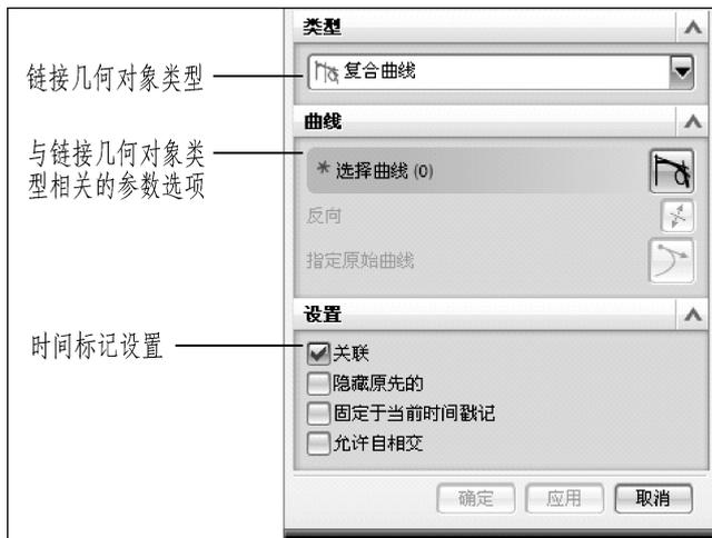
图 8.31 【WAVE 几何链接器】对话框
