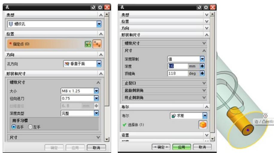
图 7.20 创建螺纹孔
