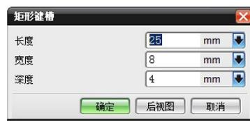
图 7.16 设置键槽尺寸参数
