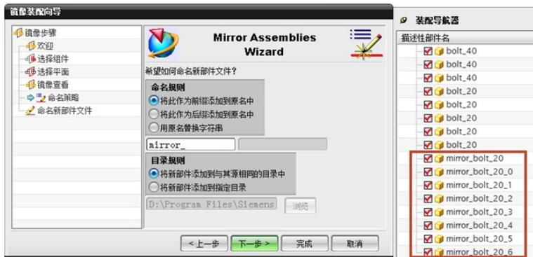
图 8.61 关联镜像的组件设置
