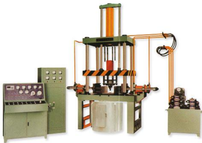
图 3-33 J45 低压铸造机
