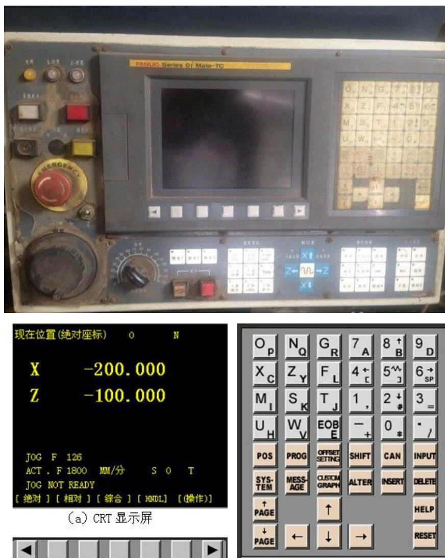
图 1-3 数控车床面板坐标显示与操作
