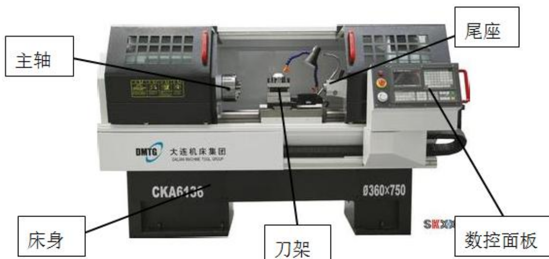
图 1-1 数控车床结构图
