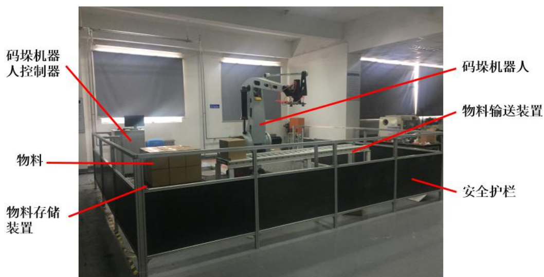
图 2-1 工业码垛生产线结构
