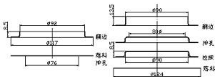
图 1-1 油封内夹圈和外夹圈的冲压工艺过程
