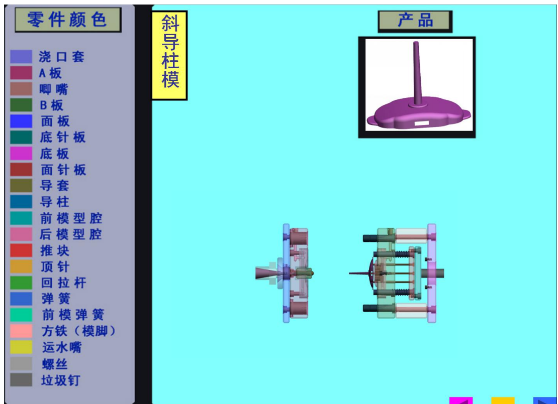
图 1-3 斜导柱模开模状态
