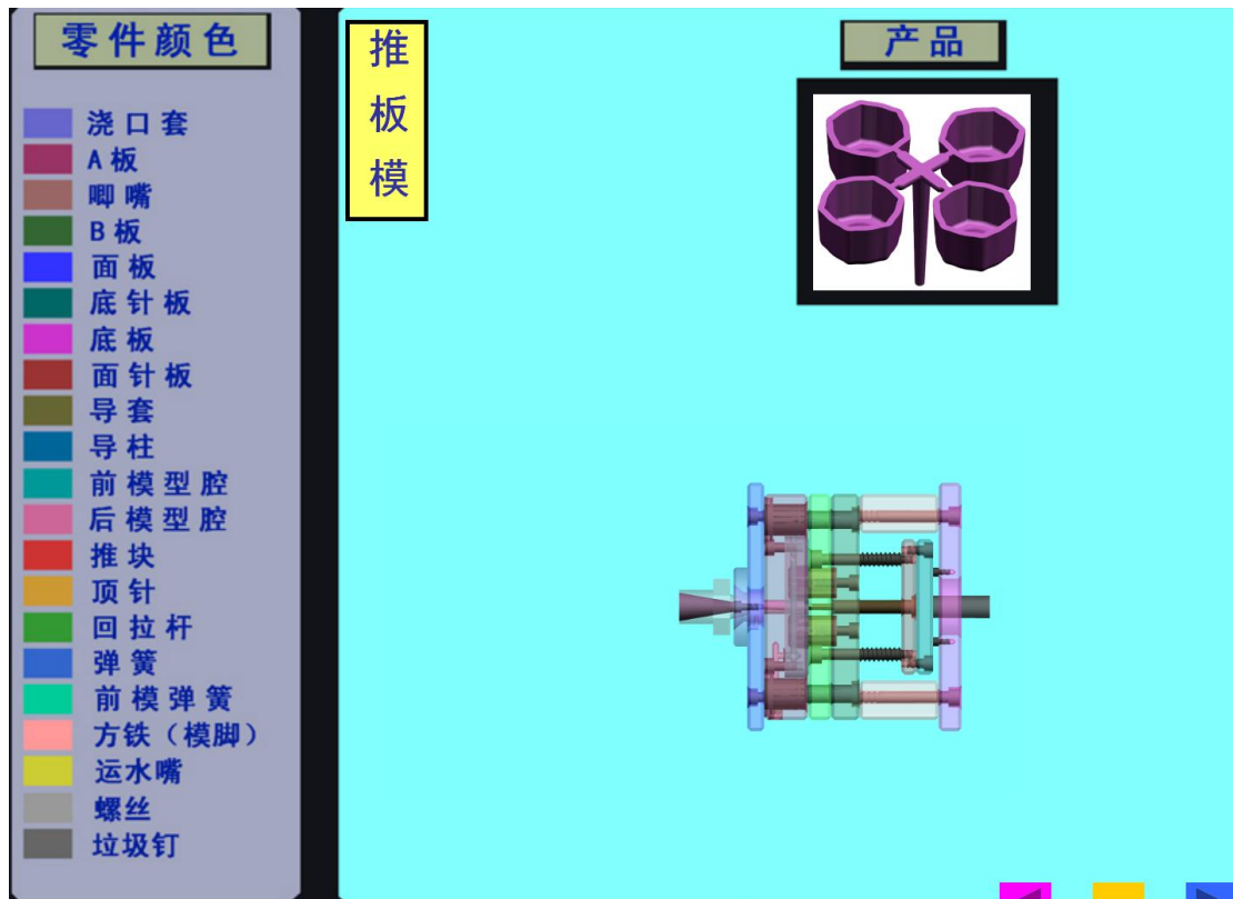
图 1-2 推板模合模状态
