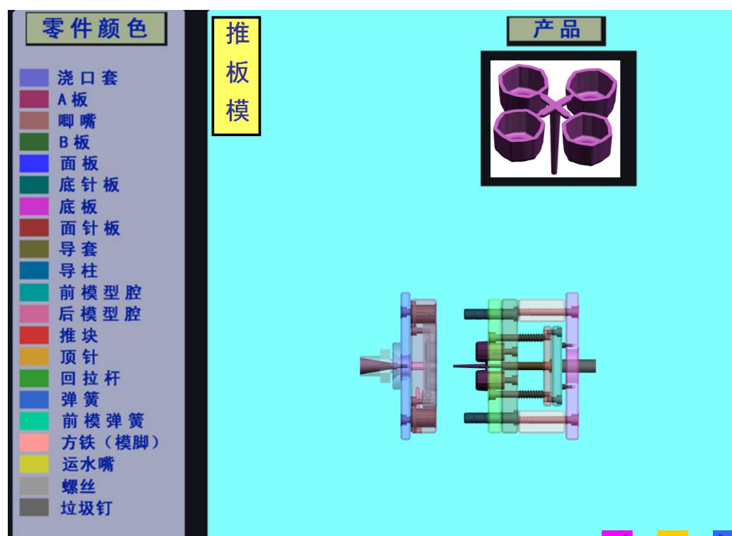
图 1-1 推板模开模状态
